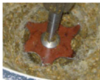
Le Dissolveur désagrège les matières entrantes en fractions très réduites
